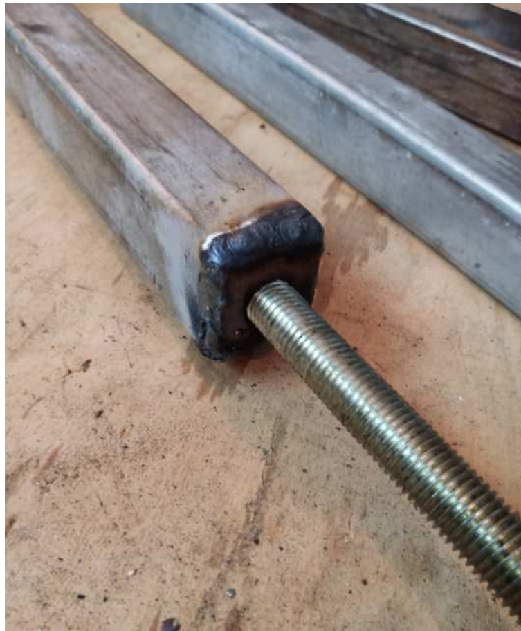
Рисунок В.4 – Гвинтова пара: розсувна консоль – спеціальний гвинт
