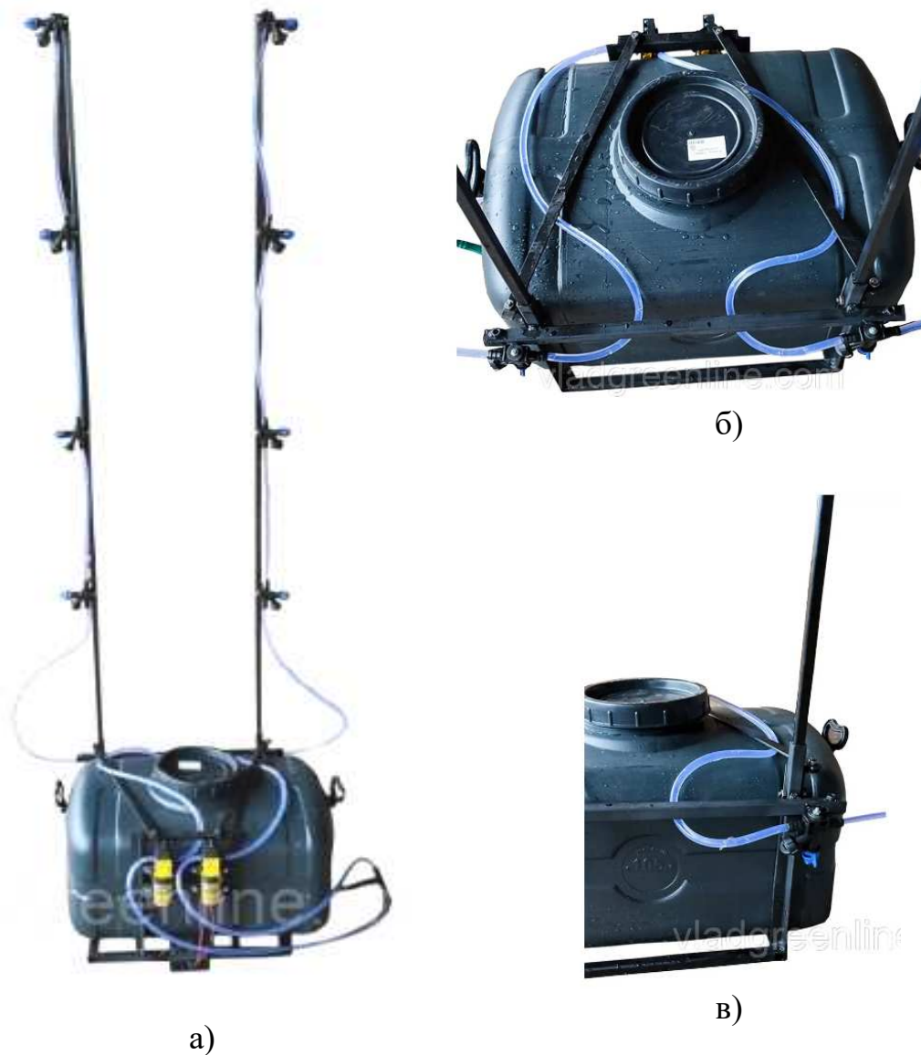
а – загальний вигляд; б – бак пластиковий; в – кріпильні елементи штанги
