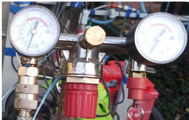
Рисунок 3.8 – Механічні датчики тиску редукційного блоку обприскувача
