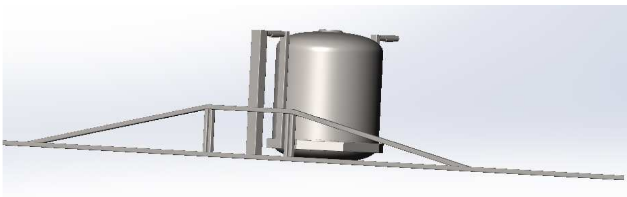
Рисунок 5.13 – Твердотільна модель підвіски штанги
