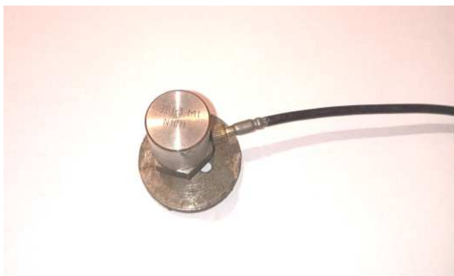
а – ДН-3-М1; б – ДН-4-М1 Рисунок 3.5 – Акселерометри
