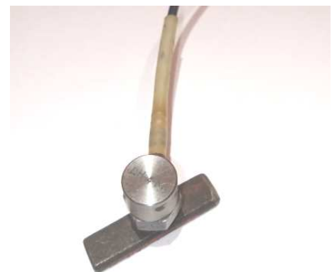
а – ДН-3-М1; б – ДН-4-М1 Рисунок 3.5 – Акселерометри
