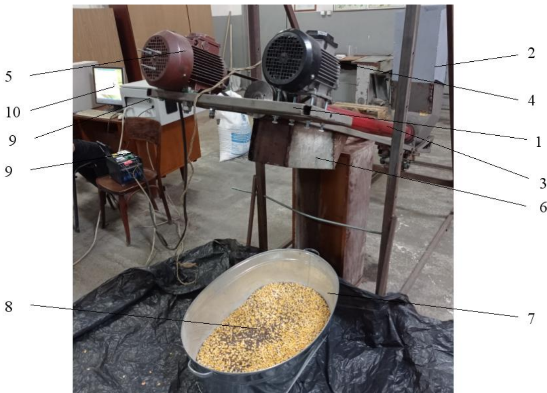
Рисунок 1. Загальний вигляд проведення експериментальних досліджень з використанням установки гвинтового конвеєра з обертовим кожухом: 1 – рама; 2 – бункер із перегородками та шиберами; 3 – обертовий кожух із розташованим в середині гвинтовим робочим органом; 4 та 5 – електродвигуни для приводу обертання кожуха та шнека; 6 – вивантажувальний патрубок; 7 – накопичувальна ємність; 8 – змішані сипкі матеріали; 9 – перетворювачі частоти струму; 10 – ПК
