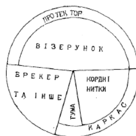
Рис. 1 Розподіл інтенсивності теплоутворення по основних елементах радіальної шини.
