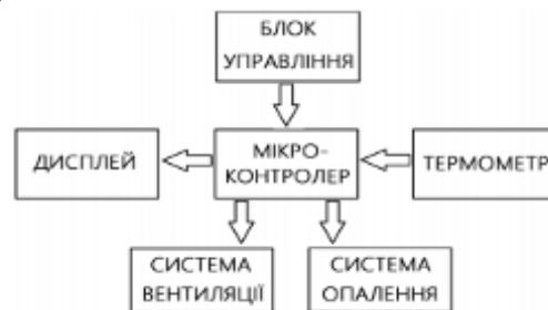
Рисунок 1. Схема пристрою контролю клімату
