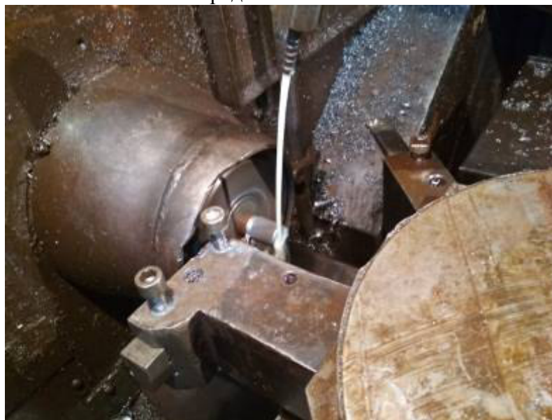
Рисунок 2. Реализация процесса изготовления насадки на станке с ЧПУ
