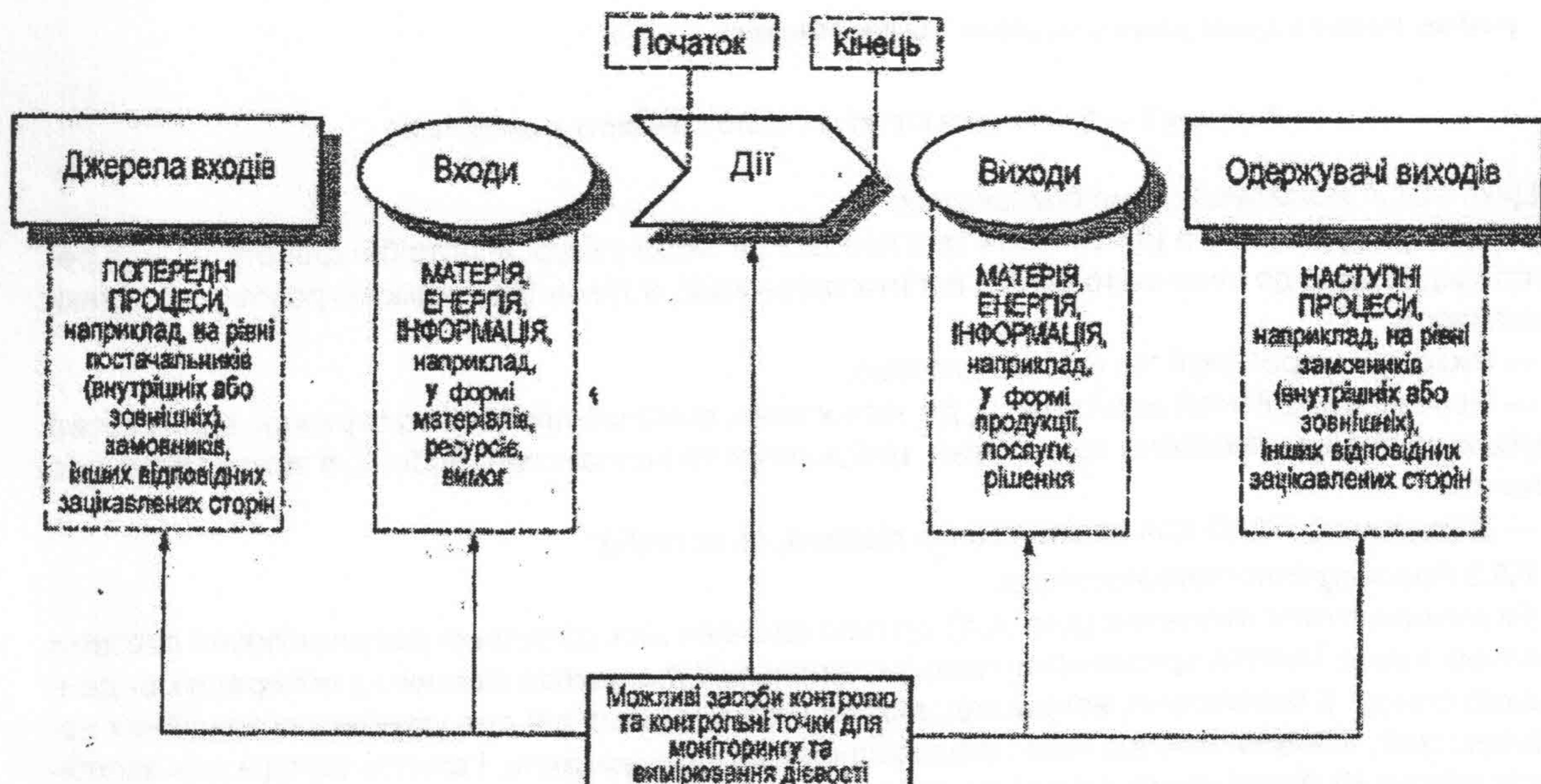
Рисунок 1 — Схематичне зображення елементів одиничного процесу
