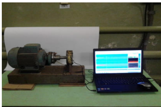
Рис. 1. Лабораторна установка шумодіагностичного контролю підшипників кочення
