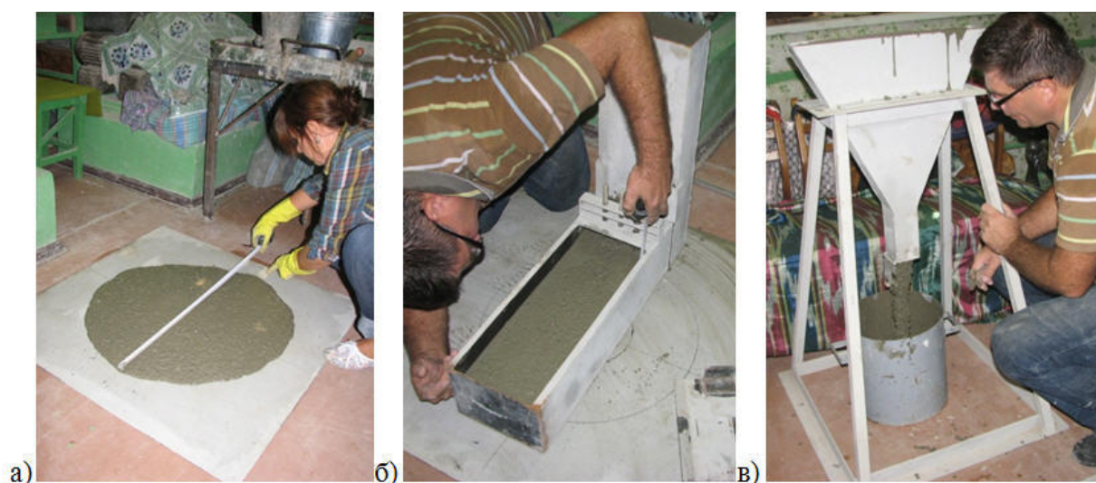
Рис. 1. Проведение испытаний самоуплотняющейся бетонной смеси: а) расплыв конуса без блокировочного кольца; б) L-образный ящик с тремя арматурными стержнями; в) V-образная воронка
