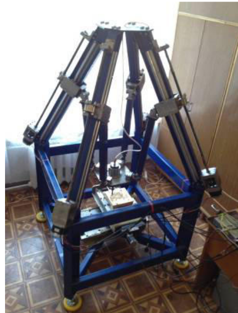
Рис. 1. Пружне пристосування (а) і зовнішній вигляд (б) стану СФВПК-4 для проведення випробувань абразивної здатності паст для притирання клапанів
